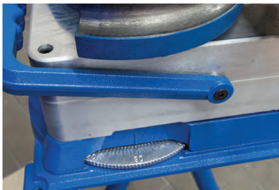
Disco graduato per la misurazione dell'angolo di curvatura Graduated disc for measuring the bending angle
